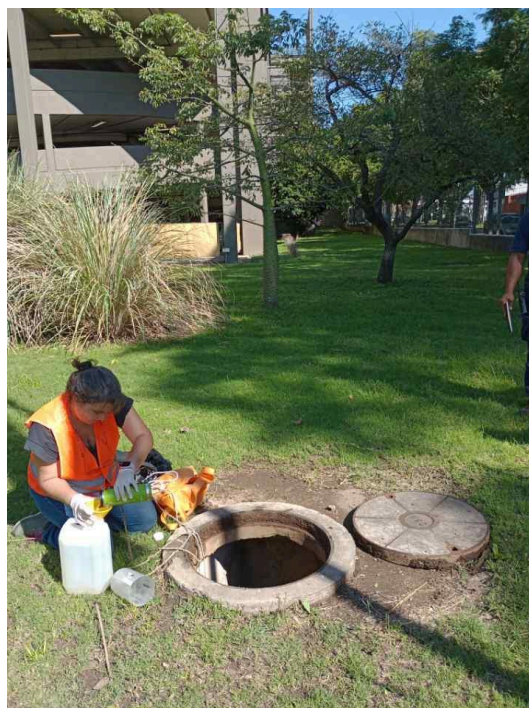
Toma de muestra conducto pluvial en el interior del Portal Rosario Shopping
